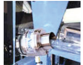
모델 6084 (51mm외경) 라인백으로 필름 조각을 쓰레기통으로 이송하는 그림
