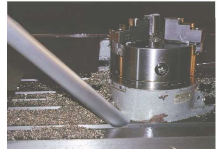
칩 백은 CNC 가공 시 발생하는 마모성이 높은 스테인리스 칩을 빠르고 효율적으로 제거합니다.
