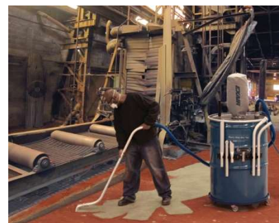
110갤런 초강력 드라이 백은 대량의 분진이 발생하는 호두껍질 블라스팅 공정에서 최대 용량의 청소 성능을 제공합니다.
