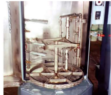
3개의 모델 2012 12인치 (305mm) 일반 에어 나이프가 이 부품 세척기의 건조 과정을 수행합니다.
