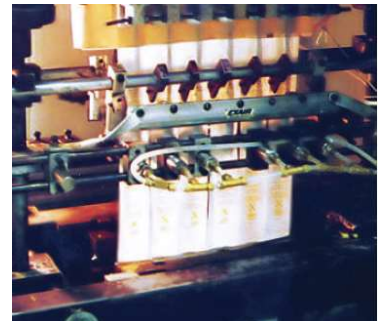
모델 2012 12인치 (305mm) 일반 에어 나이프는 머스타드를 채우기 전에 머스타드 팩을 개봉합니다.
