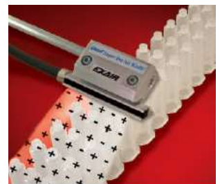
소형 Model 112203 3"(76mm) Gen4 슈퍼 이온 에어나이프 시스템은 포장 전에 주사기 표면의 정전기와 오염물을 제거합니다.
