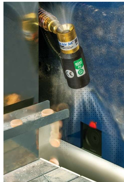
Model 8294 Gen4 이온 에어 젯과 Gen4 전원공급장치는 정제 생산 설비의 카운팅 센서 창에 발생한 정전기를 제거하고 먼지를 제거합니다.
