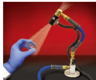
Model 8194-9362 Gen4 Stay Set 이온 에어 젯 키트는 계측기에 장착하기 전 유리 렌즈의 먼지를 제거합니다.
