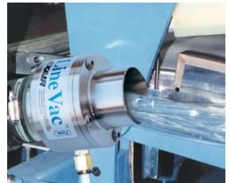
모델 6084 2인치 (51mm) 라인백은 셀로판 자투리를 폐기물 통으로 운반합니다.
