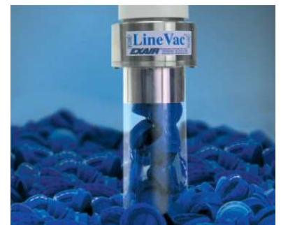
특수한 나사형 라인백 (Threaded Line Vac)은 흡입구에 호스를 연결할 수 있는 매끄러운 직경과 배출구에 PVC 파이프에 연결할 수 있는 나사산이 있도록 설계되었습니다.
