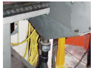
모델 150200 2인치 (51mm) 헤비 듀티 라인백은 컨베이어 가장자리에서 떨어지는 금속 부품을 이송합니다.
