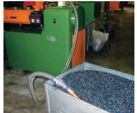
모델 6083 1-1/2인치 (38mm) 라인백은 플라스틱 펠릿을 압출기의 증력식 호퍼로 이송합니다.
