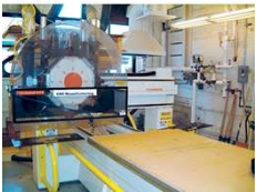
퍼듀대학교의 CNC 라우터는 4피트 x 8피트(1,219 x 2,438mm) MDF 판재 22장을 가공하여 절삭 시험을 수행했습니다
