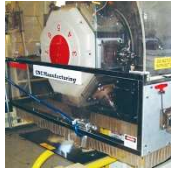
EXAIR 콜드건은 안전 보호 커버 내부에 장착되었습니다.
