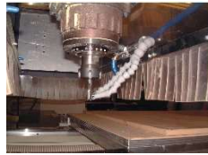
EXAIR 모델 5315 콜드건은 차가운 냉기를 공급하여 공구 온도를 낮게 유지합니다.
