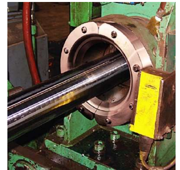
모델 2404 4인치 (102mm) 슈퍼 에어 와이프는 공정 후 강봉을 세정합니다.
