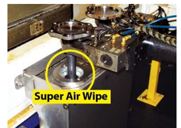
액슬의 플랜지 끝단은 슈퍼 에어 와이프를 통과하면서 가공 후 발생한 칩을 블로오프합니다.
