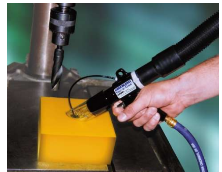
모델 6394 깊은 구멍용 백유건 다목적 시스템은 드릴 가공된 플라스틱 부품 내부의 칩을 효과적으로 제거합니다.
