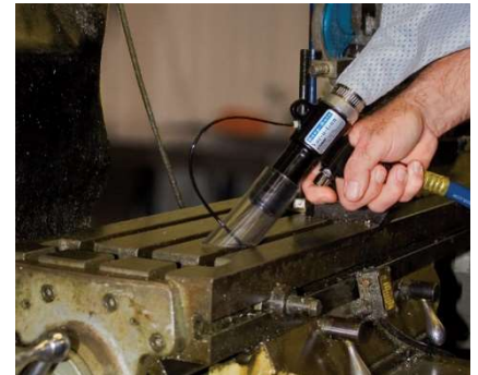
모델 6194 깊은 구멍용 백유건은 밀링 머신의 T-슬롯 내부를 깨끗하게 청소합니다.
