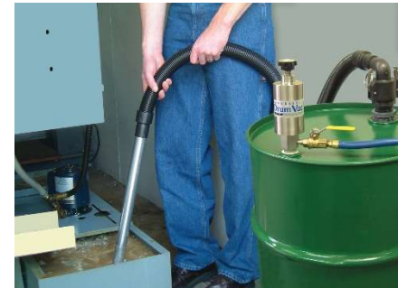
양방향 드럼백은 모든 밀폐형(Closed Head) 드럼의 3/4 NPT 번(Bung)에 장착할 수 있도록 설계되었습니다. 사진의 모델 6196-30 30갤런 시스템은 CNC 장비의 절삭유 탱크(Coolant Sump)를 비우는 작업에 사용되고 있습니다.
