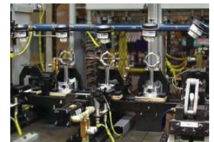
(5) 개의 모델 120022 2인치(51mm) 공기초증폭기는 트럭 피스톤을 냉각합니다.
