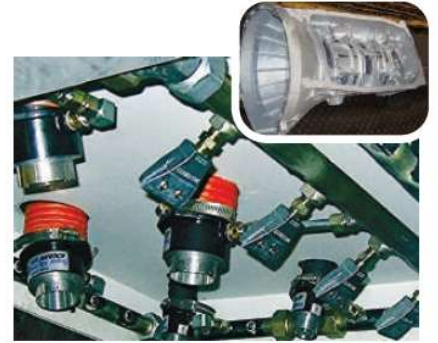
모델 120022 2인치(51mm) 공기초증폭기와 모델 1122 2인치 플랫폼 슈퍼 에어 노즐은 가공 후 변속기를 블로오프하는 데 사용됩니다.
