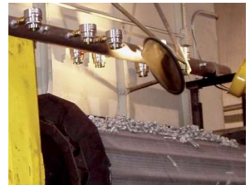
금속 부품은 여러 대의 모델 6042 2인치(51mm) 조절형 공기 증폭기를 사용하여 건조됩니다.
