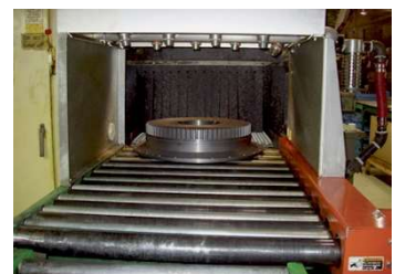
여러 대의 조절형 공기 증폭기가 고온 세척 공정을 마치고 나오는 대형 가공 주조품을 건조하고 냉각합니다.
