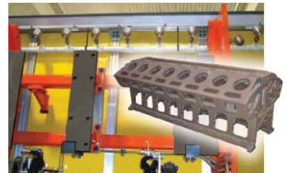
모델 6042 2인치 (51mm) 조절형 공기 증폭기가 16기통 디젤 엔진에서 엔진에서 냉각수를 불어내어 제거합니다.
