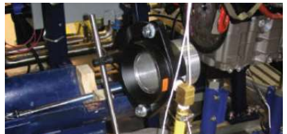
모델 120024 4인치 (102mm) 슈퍼 공기 증폭기가 동력계 시험 중엔진을 냉각하고 있다.
