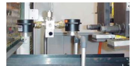
(2)개의 모델 120022 2인치(51mm) 공기초증폭기는 부품 컨베이어를 따라 이동하는 소형 부품을 건조합니다.
