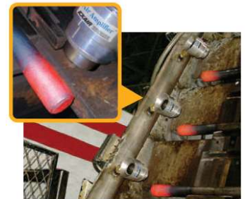
스crew 피팅이 장착된 모델 6042 2인치(51mm) 조절형 공기 증폭기는 허브를 장착하기 전에 유도 가열된 액슬을 냉각합니다.
