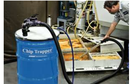
칩 트래퍼는 오염된 절삭유와 칩을 동시에 흡입하여 효율적으로 회수합니다.
