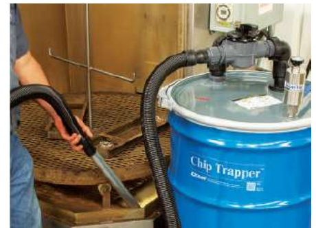
칩 트래퍼는 부품 세척기에 사용되는 세척액에서 칩 및 기타 고형 이물질을 효율적으로 제거합니다.
