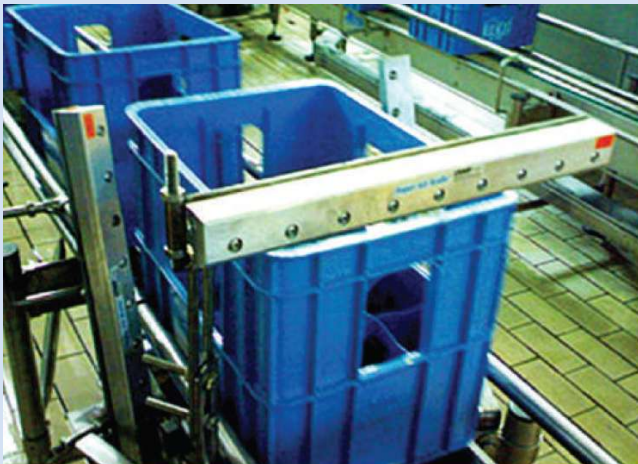
모델 110018 18인치 (457mm) 슈퍼 에어 나이프 3개가 크레이트를 완전히 둘러싸고 바람을 불어내어 즉시 적재할 수 있도록 합니다.
