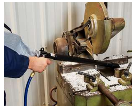
모델 6392 백유건 다목적 시스템은 플라스틱 절삭 부스러기 및 각종 이물질을 신속하게 흡입·제거할 수 있습니다.
