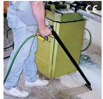
모델 6192 백유건 수거 시스템은 흡착재, 칩 및 각종 이물질을 효율적으로 흡입·회수할 수 있습니다.
